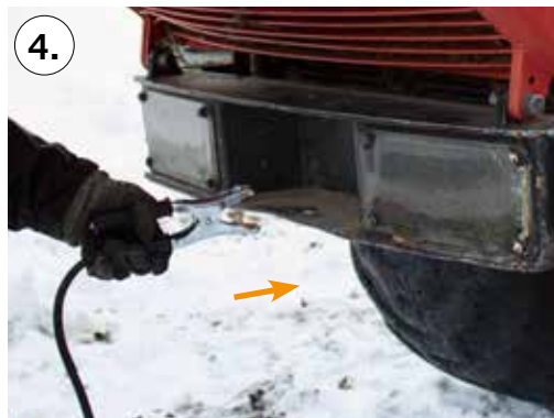
4. Anslut svart kabel till chassi (med tillräckligt avstånd från batteriet) på maskinen som ska ge starthjälp.
