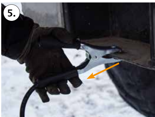
5. Ta först bort klämman från chassi på maskinen som gett starthjälp.
