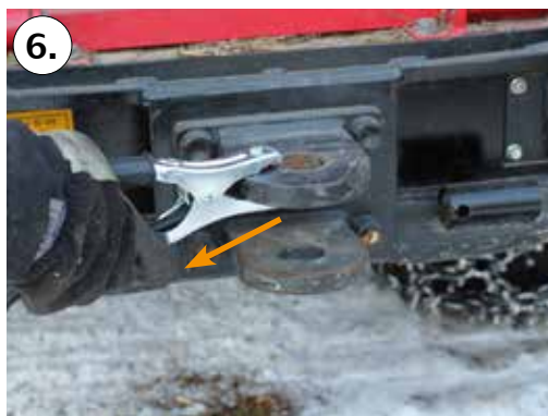
6. Ta bort på klämman från chassi på maskinen med startproblem. Efteråt bortkopplas klämmorna på röd kabel i valfri ordning.
