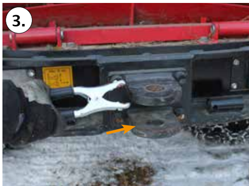
3. Anslut svart kabel till chassi (med tillräckligt avstånd från batteriet) på maskinen med startproblem.
